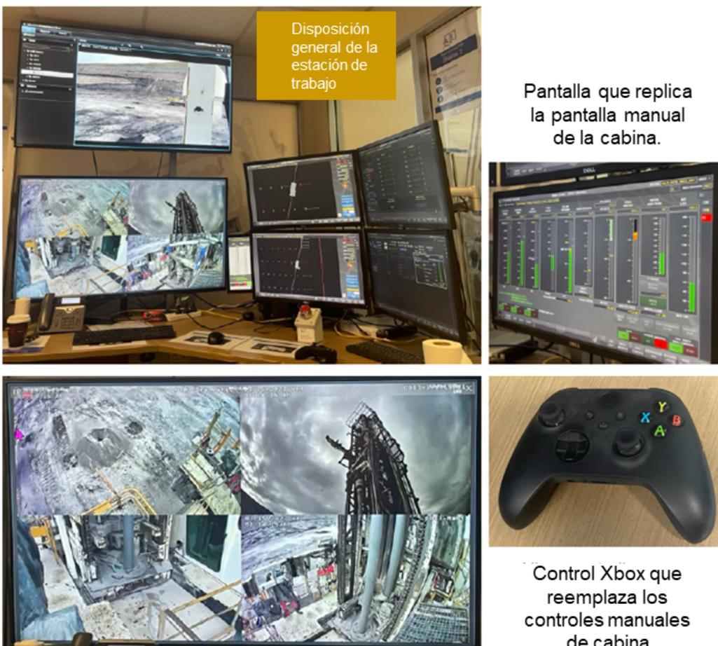
Figura 9: Interfaz y estación de trabajo autónoma de perforación de pozos de voladura
