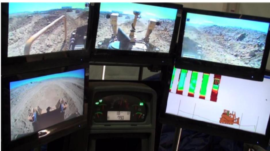
Figura 11: Interfaces proporcionadas para experimentos de interfaz de topadora remota (Dudley, 2014)
